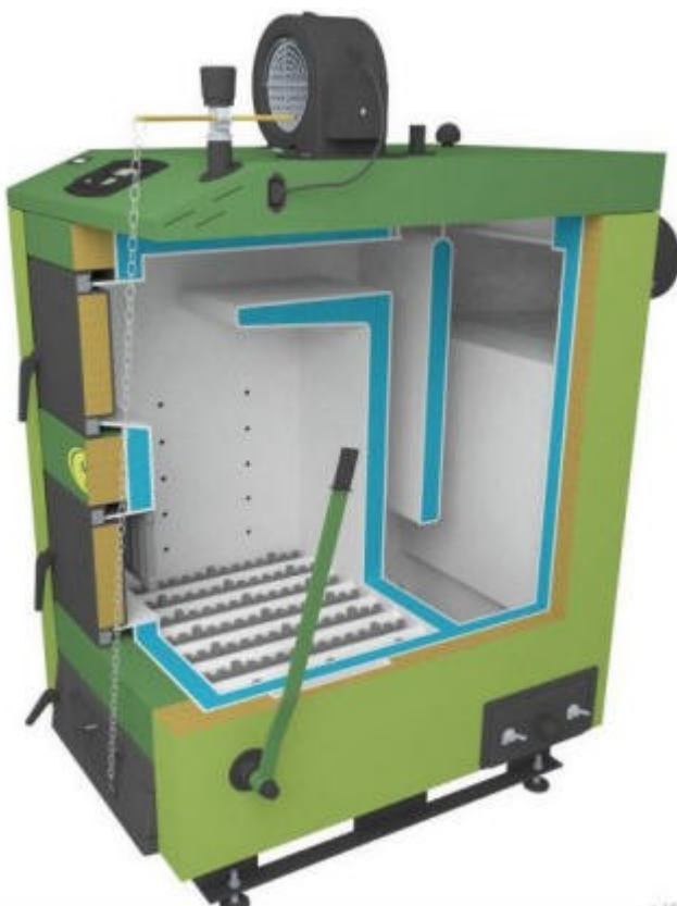
Rys. Schemat pracy kotła z dolnym spalaniem, po prawej kocioł z dolnym spalaniem firmy SAS. Kocioł wentylatorowy
