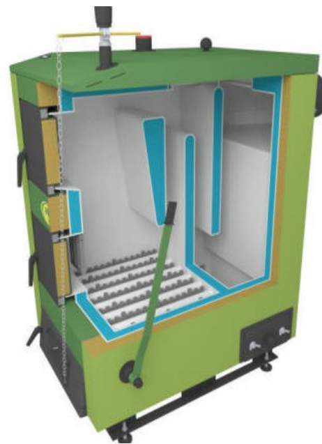
Rys. Schemat pracy kotła z dolnym spalaniem, po prawej kocioł z dolnym spalaniem firmy SAS. Kocioł wentylatorowy
